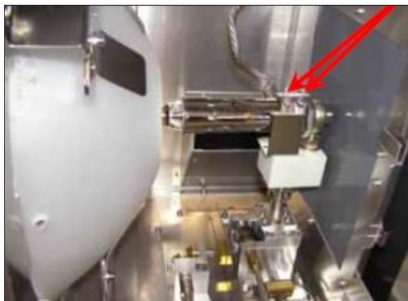
Снимите лампу с соединительной части лампы, поддерживая обе металлические части лампы. Снимите лампу с отражателя.
