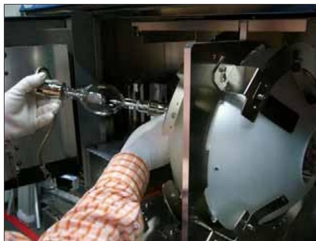
Не прикасайтесь к стеклянным частям лампы и к зеркальной поверхности рефлектора. При их касании, протрите части, как это указано в Предостережении 1.
