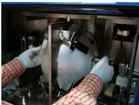
Делайте все аккуратно, чтобы избежать удара лампы об отражатель, ламповый блок или другие жёсткие части.
