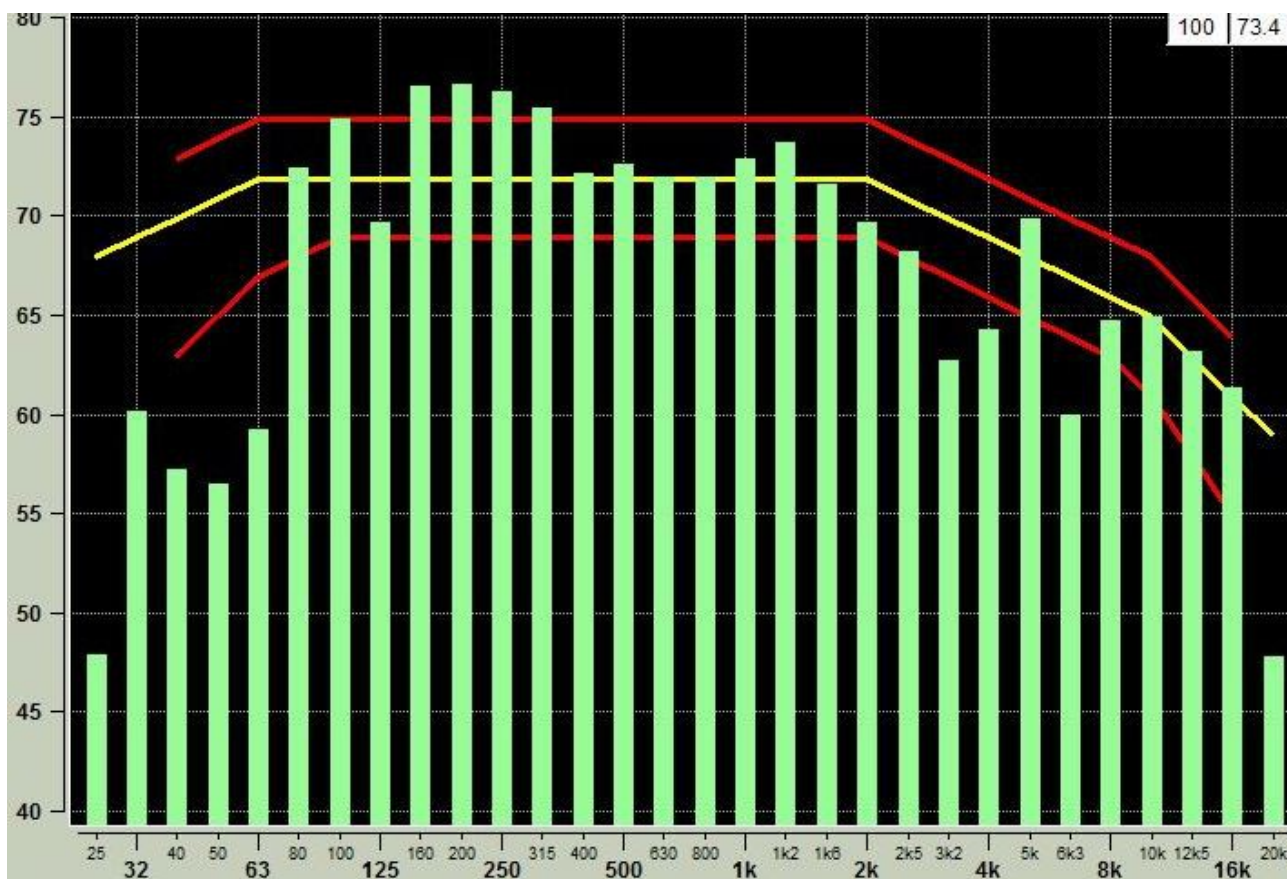
АС П. Результат измерения (85 дБ, 1 м, регуляторы тембров в среднем положении, эквалайзер Nor)
