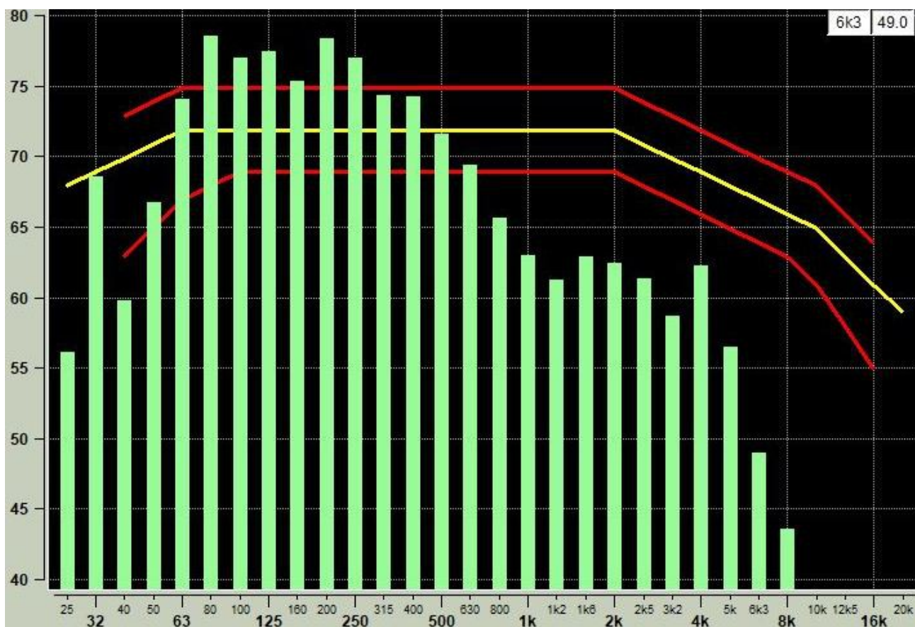
Сабвуфер. Результат измерения (85 дБ, 1 м, регуляторы тембров в среднем положении, эквалайзер Nor)
