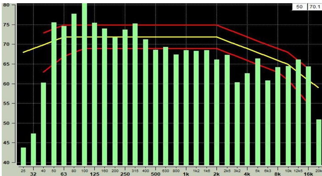
Комплекс в целом. Результат измерения (85 дБ, 1 м, регуляторы тембров в среднем положении, эквалайзер Nor)
