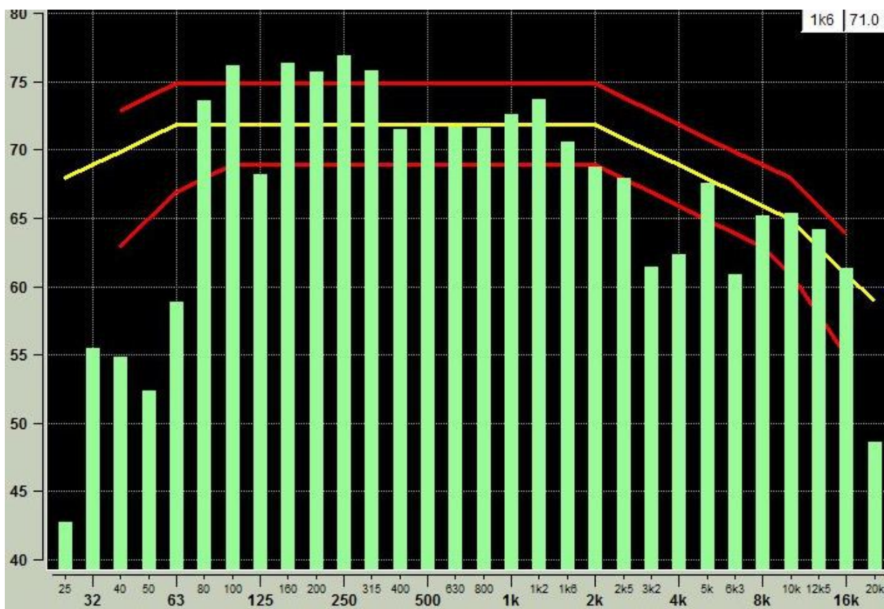
АС Л. Результат измерения (85 дБ, 1 м, регуляторы тембров в среднем положении, эквалайзер Nor)
