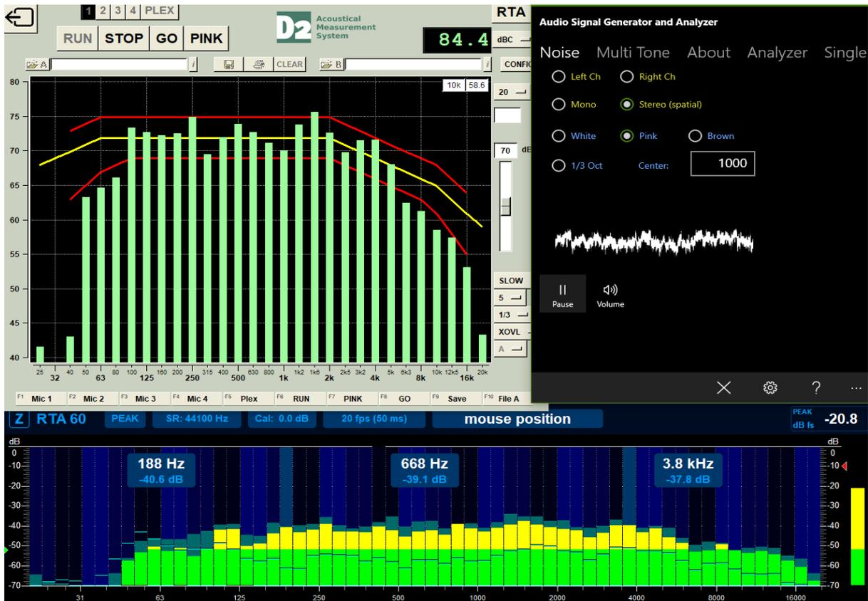
Замеры характеристик активных и пассивных колонок с сабвуфером в пассивном режиме.
